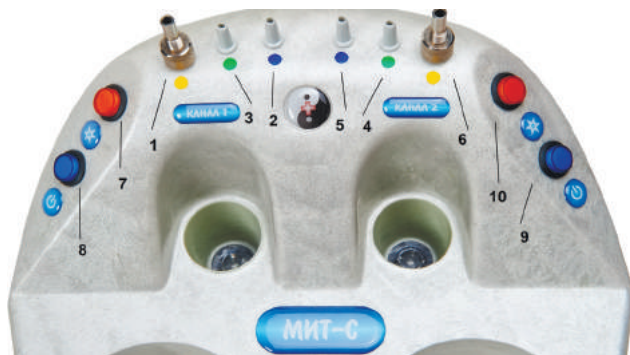
Рис. 2 Кнопки управління та штуцери для підключення колб.
